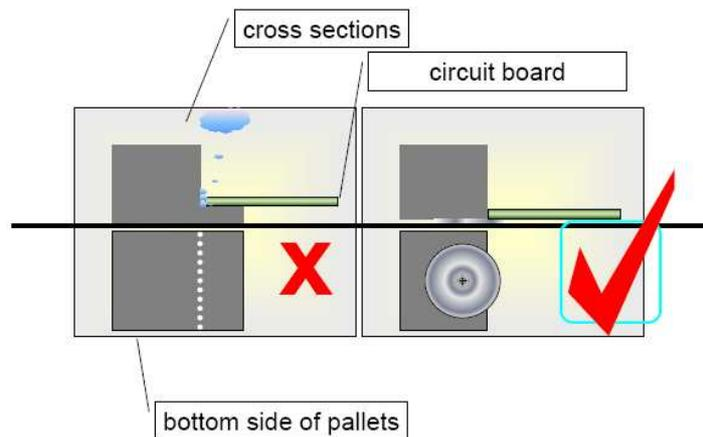
Sogenannte Schatteneffekte sollten während des Auftrages des Flussmittels vermieden werden, ebenso während des Kontakts mit der Lötwellen. Dies kann durch Minimierung des Höhenunterschiedes zwischen der Unterseite des Lötmasken oder anderer Hilfsmittel und der Oberfläche auf der Lötseite der Leiterplatte (Restmaterialstärke der Lötmaske) erreicht werden.
