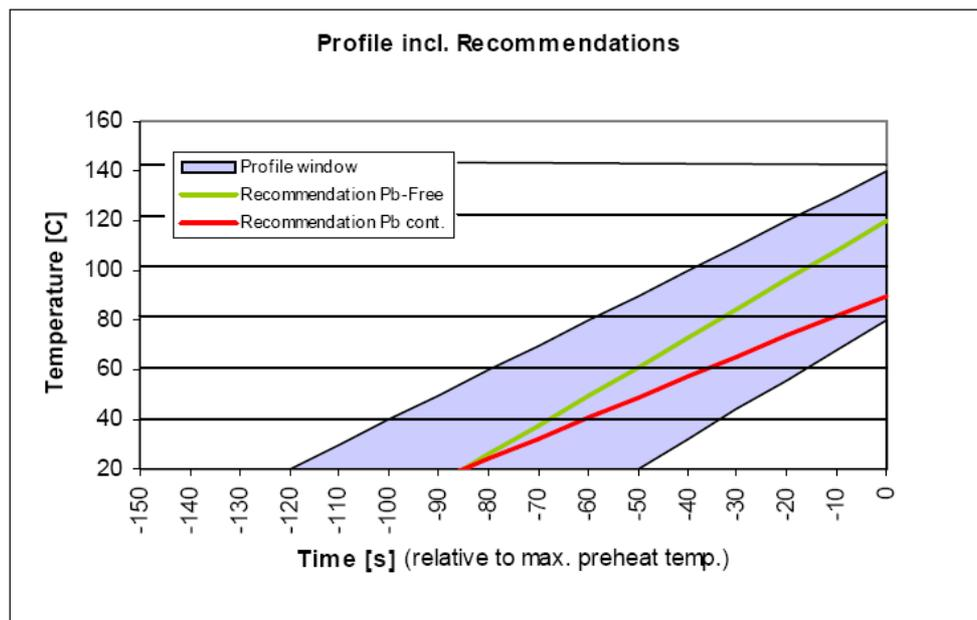
Die Eignung eines Profils sollte für jede Anwendung im Hinblick auf kosmetische Erscheinung, incircuit Test und Zuverlässigkeit sorgfältig ausgewertet werden.
